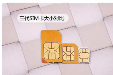
图 2.4-1 三代 SIM 卡尺寸
